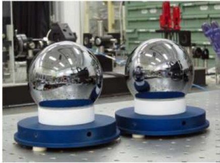
図4 NMIJでキログラムを実現するために用いられたシリコン単結晶球体（写真提供：産業技術総合研究所）
