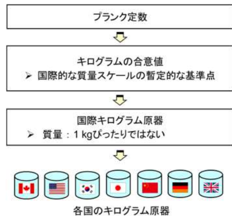
図3 新しいキログラムの定義にもとづく国際キログラム原器の質量を決定するための国際基準値「キログラムの合意値」にもとづく質量標準供給体系
