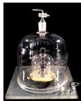
図 1 国際度量衡局が管理する国際キログラム原器 (Photograph courtesy of the BIPM)
