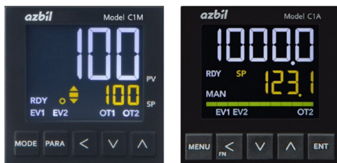
図 3 前面表示 (左: 形 C1M, 右: 形 C1A)
