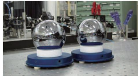
写真 2  $^{28}\text{Si}$  単結晶球体 (写真提供：産業技術総合研究所)
